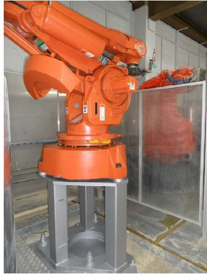
Mit diesem Roboter (Fuß RUST GRIP) werden die Formen in die Behälter (Bild rechts unten) mit der Sandmasse getaucht.
